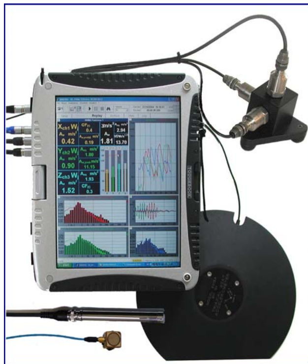
SoundBook con differenti trasduttori: accelerometro triassiale, disco ISO triassiale per misure sul sedile, accelerometro triassiale miniatura per esposizione mano – braccio, microfono di misura
