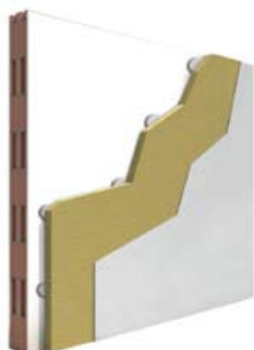
Controparete con Isolastra incollata alla muratura esistente
