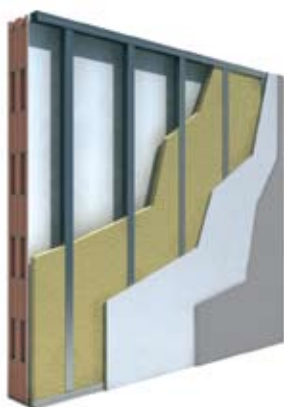
Controparete ad orditura metallica autoportante
